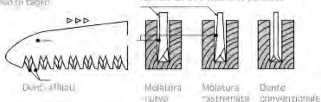
I denti ARS con molatura rastremata hanno un'affilatura a lama di coltello. La lama ARS brevettata produce tagli puliti, precisi e veloci con sforzi molto ridotti. L'applicazione della cromatura temprata rende la lama robusta e resistente alla ruggine. La tempra ad impulsi aggiunge maggiore durata.
