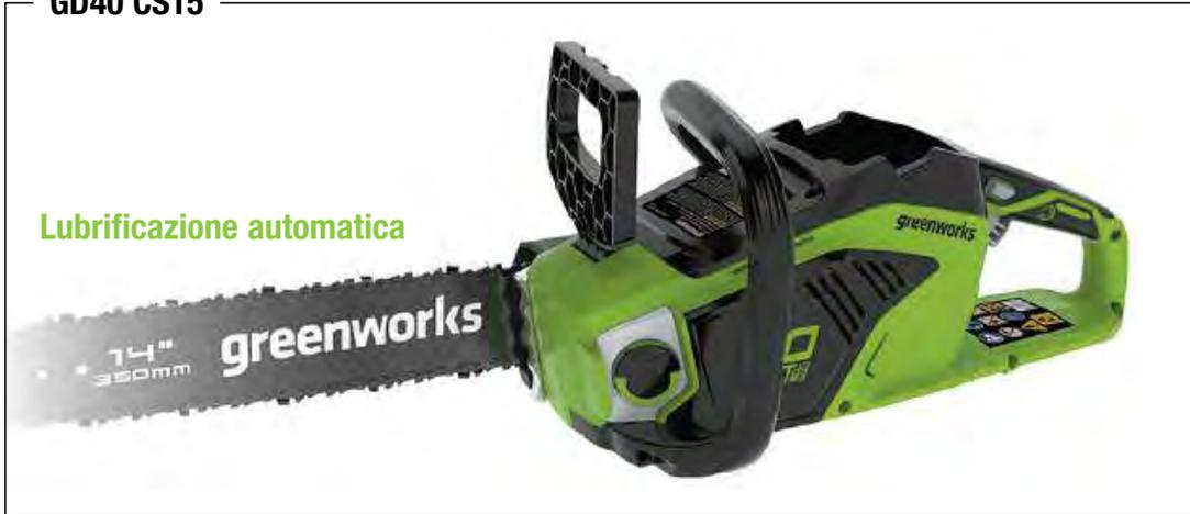
**GD40 CS15** Motosega motore brushless - Pompa olio automatica - Lunghezza barra 35 cm 3/8" b.p. 1,3 mm Catena 3/8" b.p. 52 maglie - Velocità catena 20 m/sec - Tempo di lavoro con Batteria 2,0 Ah 20 min circa Tempo di lavoro con Batteria 4,0 Ah 40 min circa - Tempo di lavoro con Batteria 6,0 Ah 60 min circa Peso 3,6 kg - € 313,00 **Fornita senza batteria e caricabatterie**
